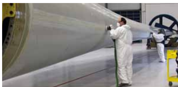
Produktion von Windenergieanlagen bei der Firma Vestas Blades Deutschland GmbH
