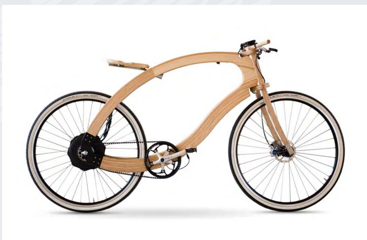
Das Wooden E-Bike ist ein Holz Pedelec, das durch die nahezu serielle und hoch automatisierte Herstellung konkurrenzfähig mit hochwertigen Elektrofahrrädern aus anderen Werkstoffen wird.
